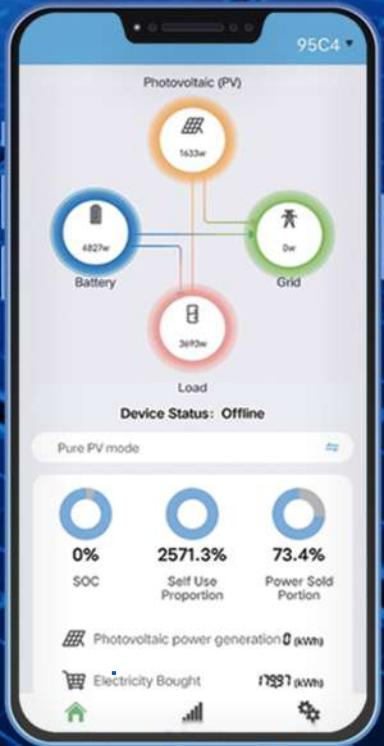
IL DIAGRAMMA DI FLUSSO È MOSTRATO NELLA HOME PAGE, MOSTRA LA DIREZIONE DELL'ENERGIA E LA POTENZA IN TEMPO REALE DI FOTOVOLTAICO, RETE, BATTERIA E CARICO. IN QUESTA PAGINA È INOLTRE POSSIBILE VISUALIZZARE LO STATO DELLE BATTERIE, LE INFORMAZIONI SULL'AUTOUTILIZZO E SUL RAPPORTO DI VENDITA, ECC.
